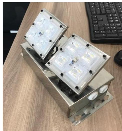
Montage des sources lumineuses en façade (standard)
