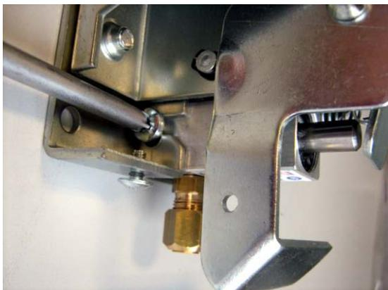
Raccorder le module au réseau cuivre.
