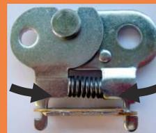
Comprimer le ressort et mettre le fusible en place
